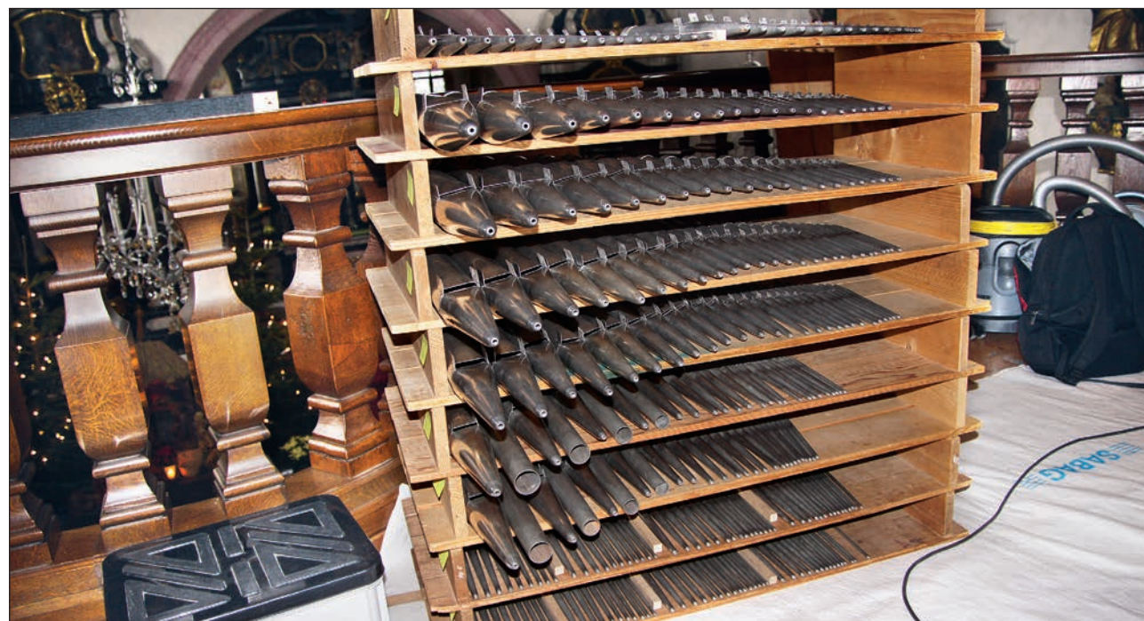
Hunderte von grossen und kleinen Orgelpfeifen werden gereinigt, kontrolliert und repariert.
